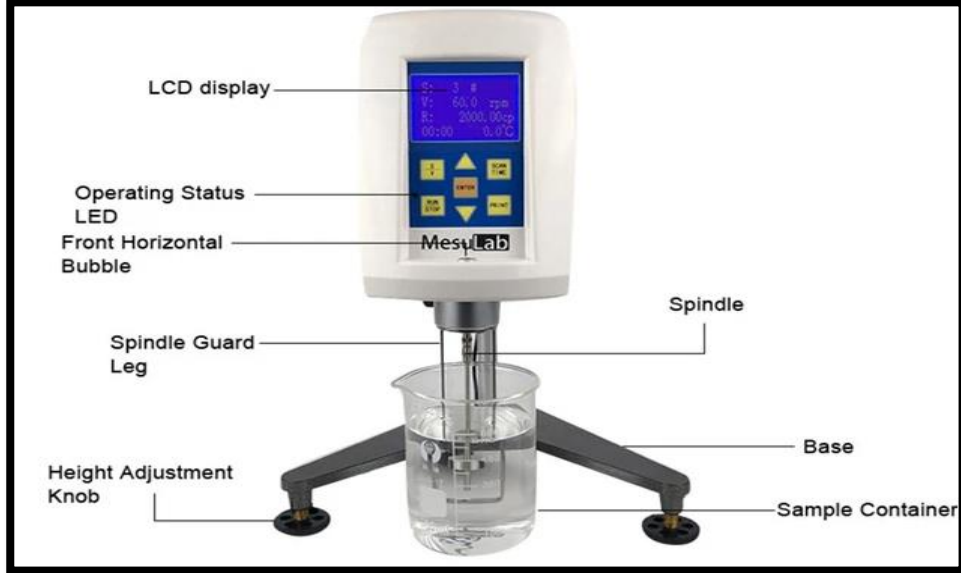
الشكل (4) جهاز الفيسكوميتير لقياس اللزوجة
