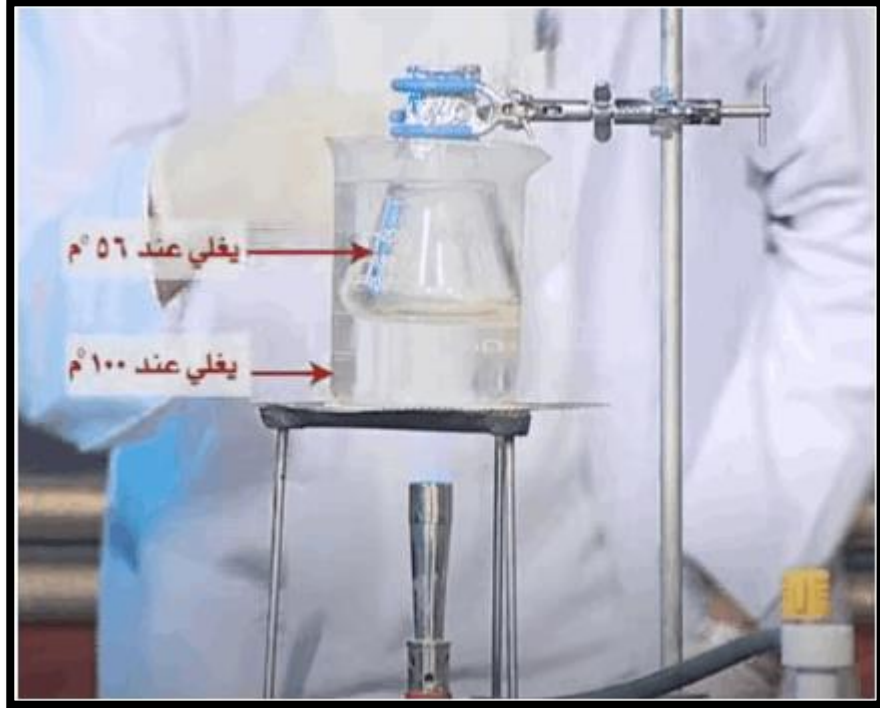
الشكل (6) جهاز تعيين الوزن الجزيئي للسوائل المتطايرة
